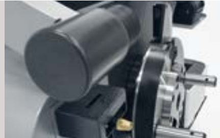
针对刀具具体情况设计的刀架
