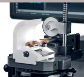
转台顺时针旋转90° (带反射器)，实现径向测量
