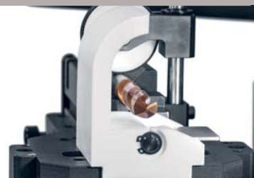
转台位于45°位置，用以测量切削刃或步进
