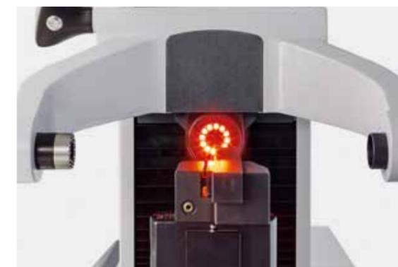
光学部件托架上配有 LED 环形灯的中心高度测量相机
