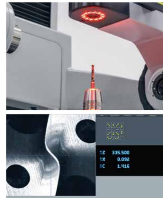
刀具面在»metis«刀具分析软件中显示并测量。
